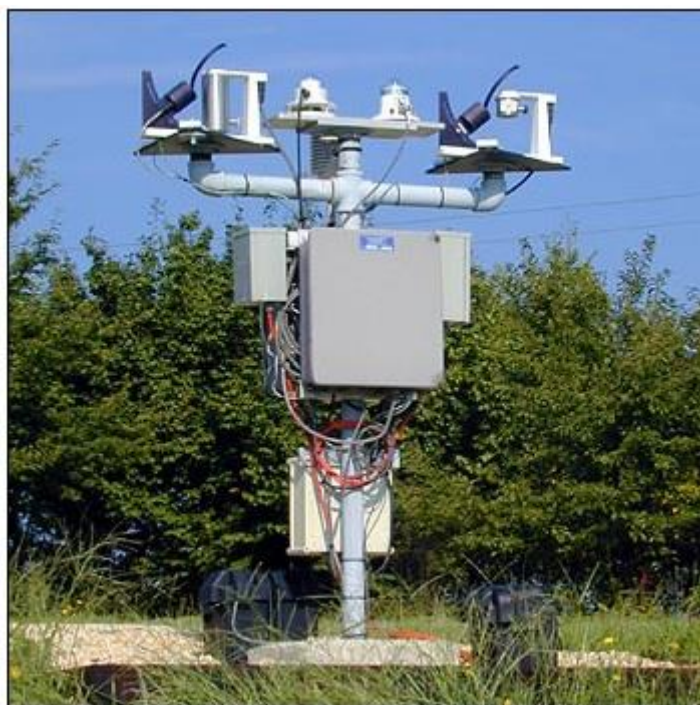
Radiometrs UV-B starojuma mērīšanai Belltsvillē, Mērilendā. Jeannie Allen fotogrāfija
